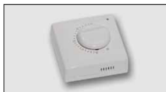
Art. H-LINE.1150.230 pokojev elektromechanický termostat - spínací proud 16(2,5)A/250V - teplotní rozsah 5-30°C - tolerance teploty ±0,5°C - indikace sepnutí svítící diodou
