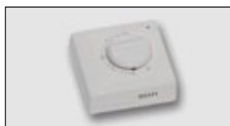
Art. H-LINE.1150.230 pokojový elektromechanický termostat - spínací proud 16(2,5)A/250V - teplotní rozsah 5-30°C - tolerance teploty ±0,5°C - indikace sepnutí svítící diodou
