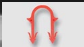
Art. DELTA.80317 spona pro přichycení trubky na izolační desku tl. 30 mm automatická aplikace pomocí tackeru H-LINE.3100
