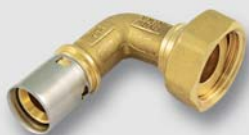
Art. TM 1710 koleno s převlečnou matkou a plochým těsněním
